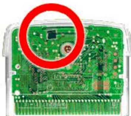
Der Solar Sensor befindet sich auf der Rückseite des Moduls, damit auch genügend UV-Licht auf ihn fällt.
